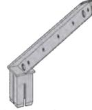
Bavolets moulés en aluminium, à emboîter en force dans les poteaux. Inclinaison à 45°, Longueur 800 mm. Trous de fixation des fils ronce ou Concertina tous les 100 mm
