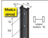
Poteau avec perçages en fond de feuillure permettant la fixation du panneau par vis à bois.
