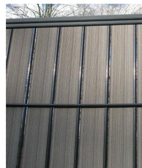
Le kit comprend 44 lames standard de largeur 48 mm et 2 lames réduites de largeur 44 mm pour les extrémités afin de permettre de fixer le panneau sur le poteau. Les lames sont reprises sur le panneau dans un profil de réception bas et dans un profil de finition haut en pvc gris.
