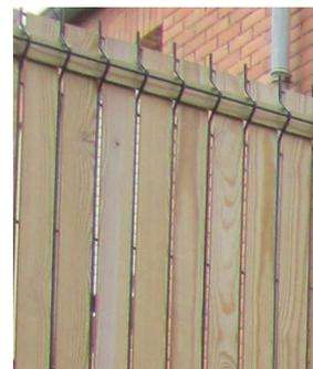
Le kit comprend 44 lattes standard de largeur 46 mm, 3 contre-lattes à mettre dans les plis du panneau et 2 lattes réduites de largeur 41 mm pour les extrémités afin de permettre de fixer le panneau sur le poteau. (Agrafes et agrafeuse à commander séparément)
