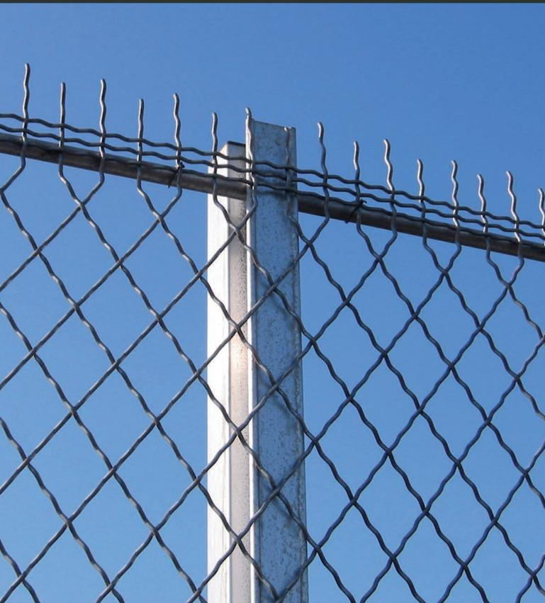
La **CLOTURE E.D.F Bordures Défensives** est constituée d'une version spéciale de nos poteaux **CLOPLUS** en aluminium brut avec trous permettant de recevoir des lisses rondes de Ø18. Un grillage aluminium est ensuite fixé sur l'ensemble lisses et poteaux. Elle est disponible en 3 types : D, B ou Bd2.
